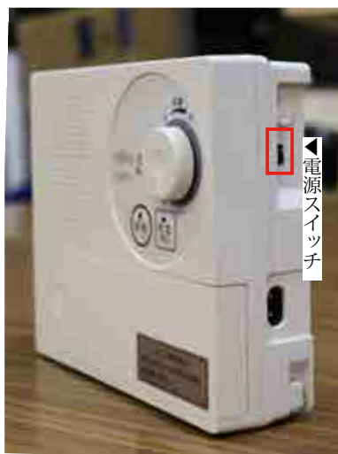
▲受信機右側の電源部分
